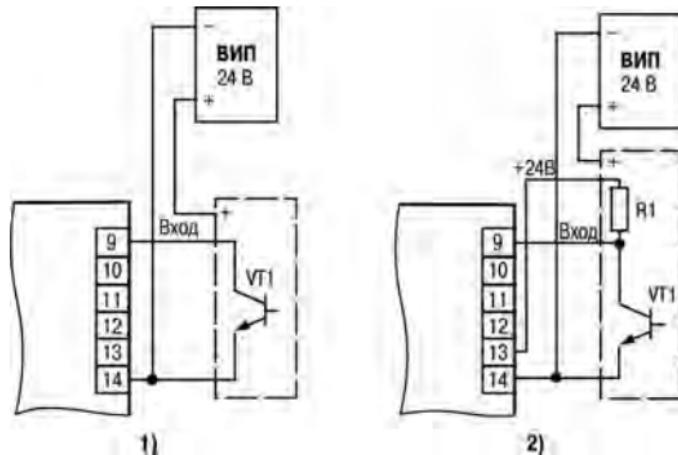
Рисунок 5.4 – Подключение датчиков с п-р-п-выходом: 1) пассивных; 2) активных
