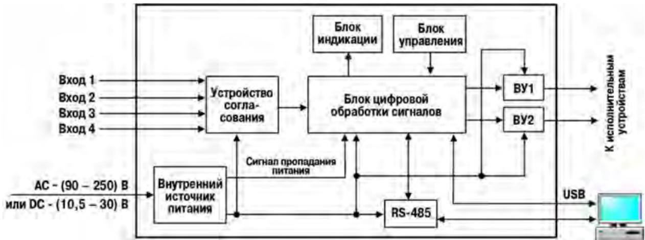
Рисунок 6.1 – Функциональная схема прибора
