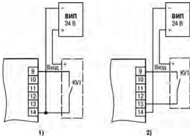
**Рисунок 5.3 – Подключение коммутационных устройств: 1) при работе с п-р-п-датчиками; 2) при работе с р-п-р-датчиками**
