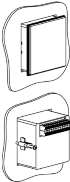
Рисунок 4.3 – Монтаж прибора щитового крепления
