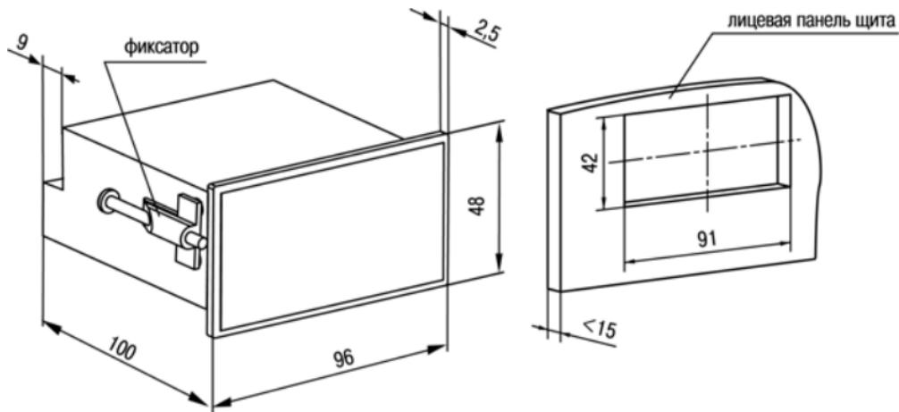
Рисунок 4.7 – Габаритные размеры корпуса Щ2
