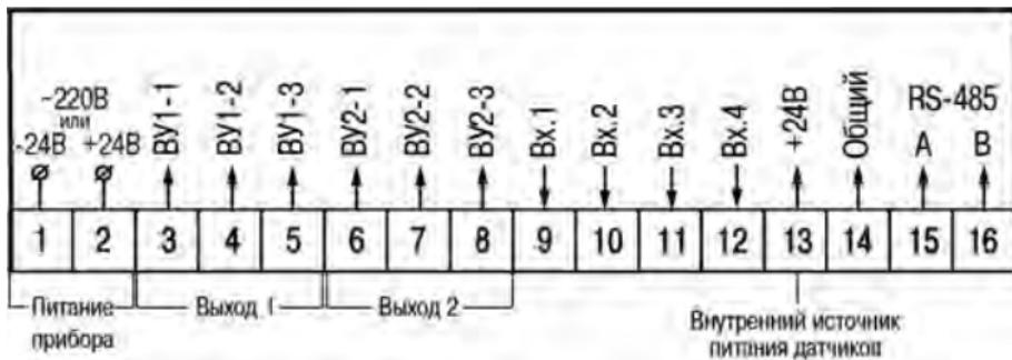
**Рисунок 5.1 – Назначение контактов клеммника**
