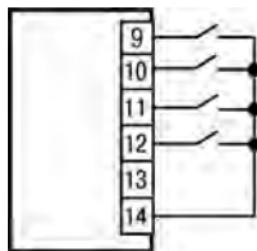
Рисунок 5.2 – Подключение коммутационных устройств типа «сухой контакт»
